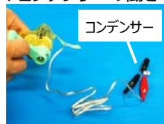
手回し発電機を回して電気を蓄える
