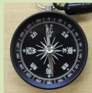
方位磁針のN極は真北より約7° 西にずれた方向を指します。
