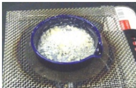
金属が溶けた水溶液の水を蒸発させ取り除く
