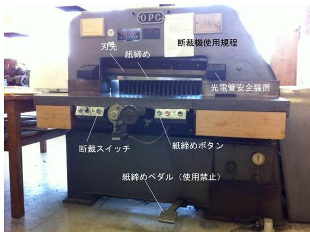
図 5-11 油圧縮高速度断裁機外観
