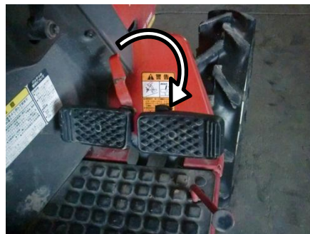
図1-22 連結金具を外した状態
