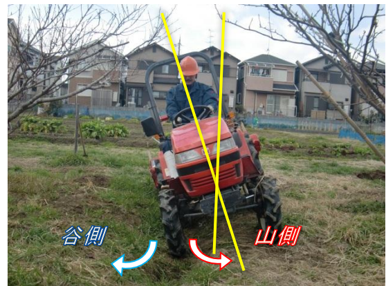
図1-21 溝に脱輪して約20°傾いた状態
