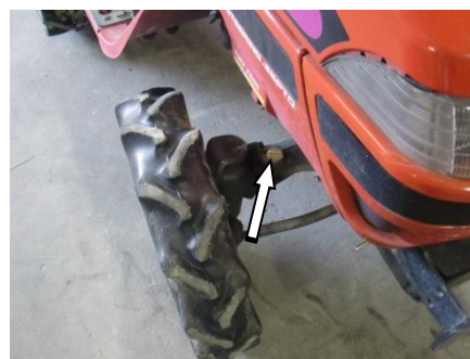
図1-10 前車軸右ケースオイル給油プラグ
