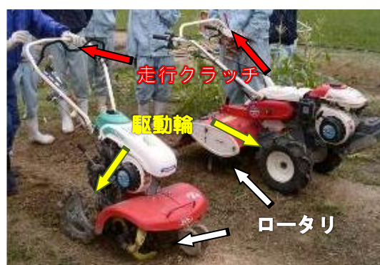
図 1-27 歩行型トラクタ 超小型(左)と小型(右)
