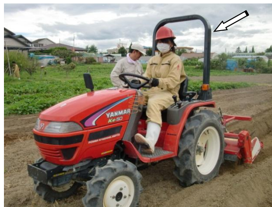
図1-17 安全フレームを装着した乗用トラクタ
