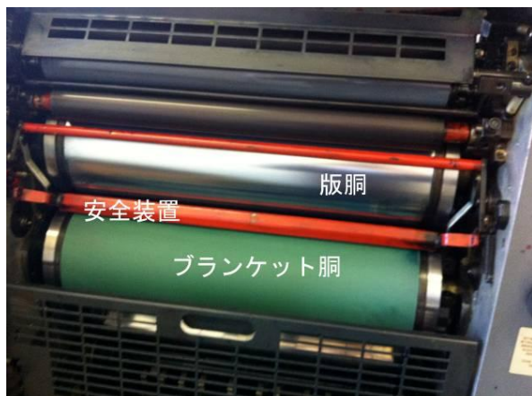
図 5 - 8 背面カバーの内部
