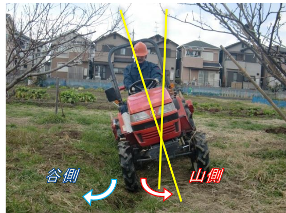
図1-21 溝に脱輪して約20°傾いた状態
